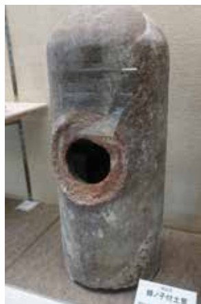
蜂ノ子付土管 溜池の水位調整のため豎樋として、従来木樋などを用いていたが、明治23年頃に伊部で土管の製造技術を応用して考案した【和気町 歴史民俗資料館蔵】
